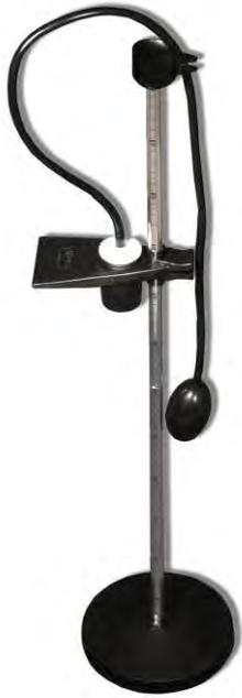
Rockabrunder einfache Ausführung. Stange aus Aluminium mit aufgeklebtem Höhenmaßstab, mit Kunststofffuß, der zur Beschwerung mit Metallkügelchen befüllt ist.
