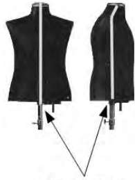
Dehnungsschlitze (durch Überzug im Original nicht sichtbar)
